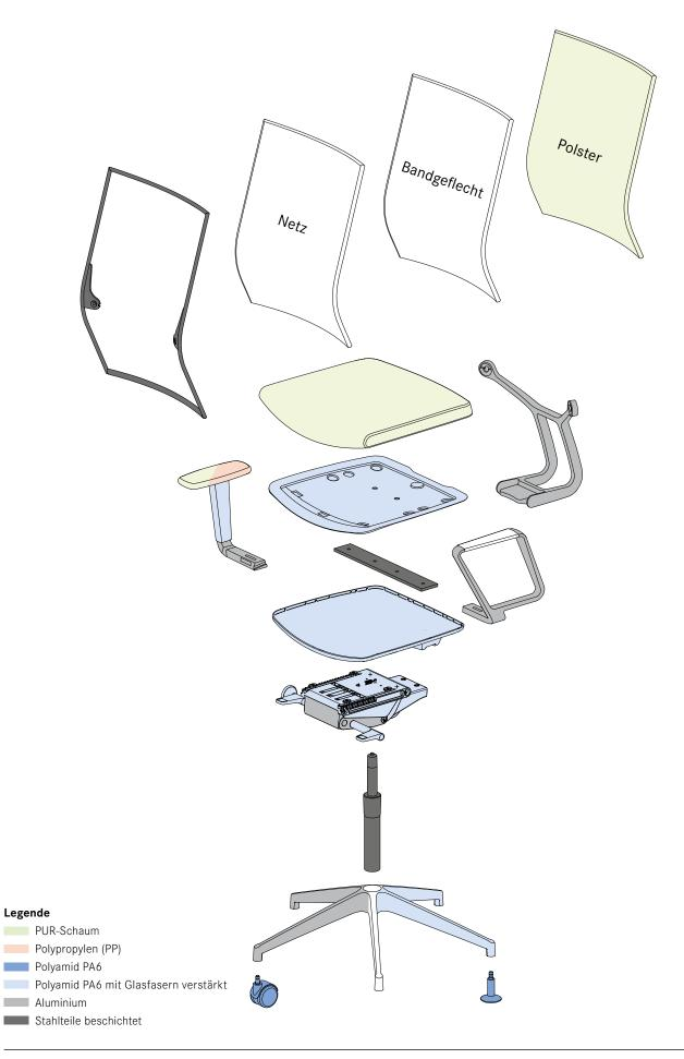
Diagon ist so konstruiert, dass nach dem Gebrauch eine Demontage erfolgen kann und die Einzelteile grösstenteils dem Recycling zugeführt werden können. Im Einzelnen werden folgende Materialien verwendet:
