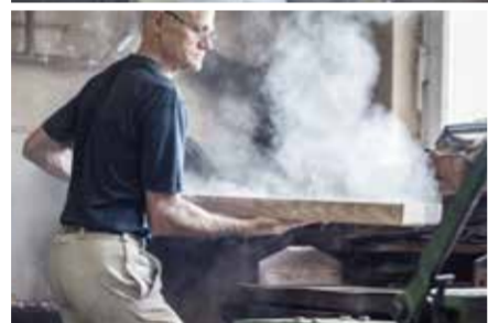
Les pièces de bois sont coupées à la longueur exacte et étuvées plus ou moins longtemps en fonction de leur section. Les pièces en bois sont ensuite courbées selon le fameux processus de cintrage du bois à la vapeur effectué par l'entreprise de cintrage du bois K. Winkler AG à Felsenau (CH).
