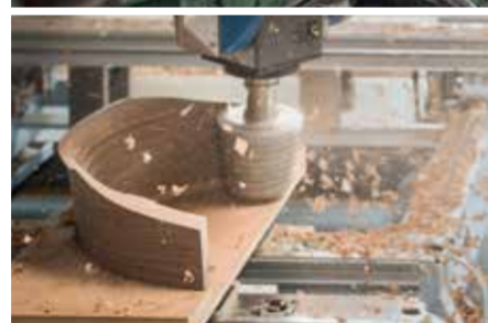
Les divers composants sont intégralement transformés, jusqu'au siège achevé, dans les ateliers de Girsberger à Bützberg près de Berne.
