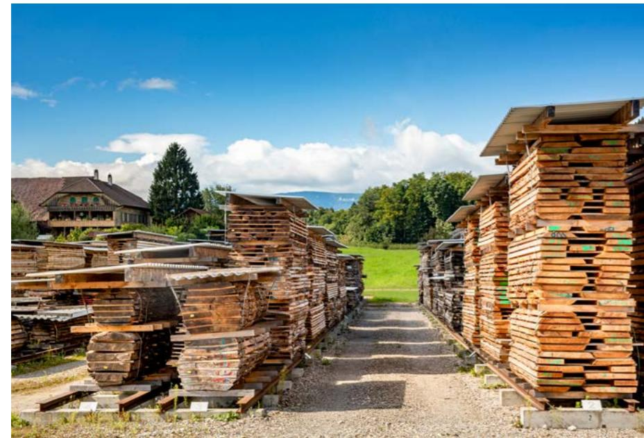
Links: In unseren Aussenlagern durchläuft unser Massivholz vor allem die ersten ein bis vier Jahre des langsamem und schonenden Trockenprozesses an der frischen Luft.
