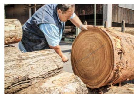
Mitte oben: An der Stirnseite des Stamms wird die Sägerichtung angezeichnet.
