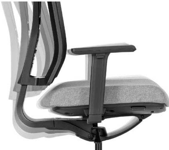
Der vordere Bereich der Flex-Synchronmechanik ist als flexible Schwinge ausgebildet, welche als Federkraftspeicher beim Zurücklehnen wirkt. Die Mechanik erlaubt eine maximale Rückenlehnenneigung von 20° und ist in die 0°-Sitzposition arretierbar.
