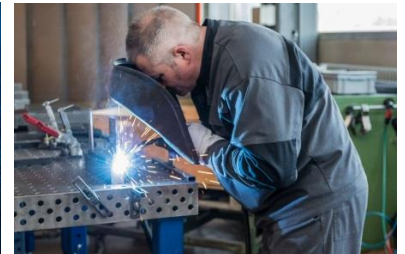
Schweissarbeiten an Klappbeschlägen
